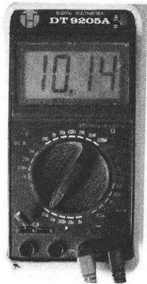
(a) 10\mu\text{F} 电解电容的测量
