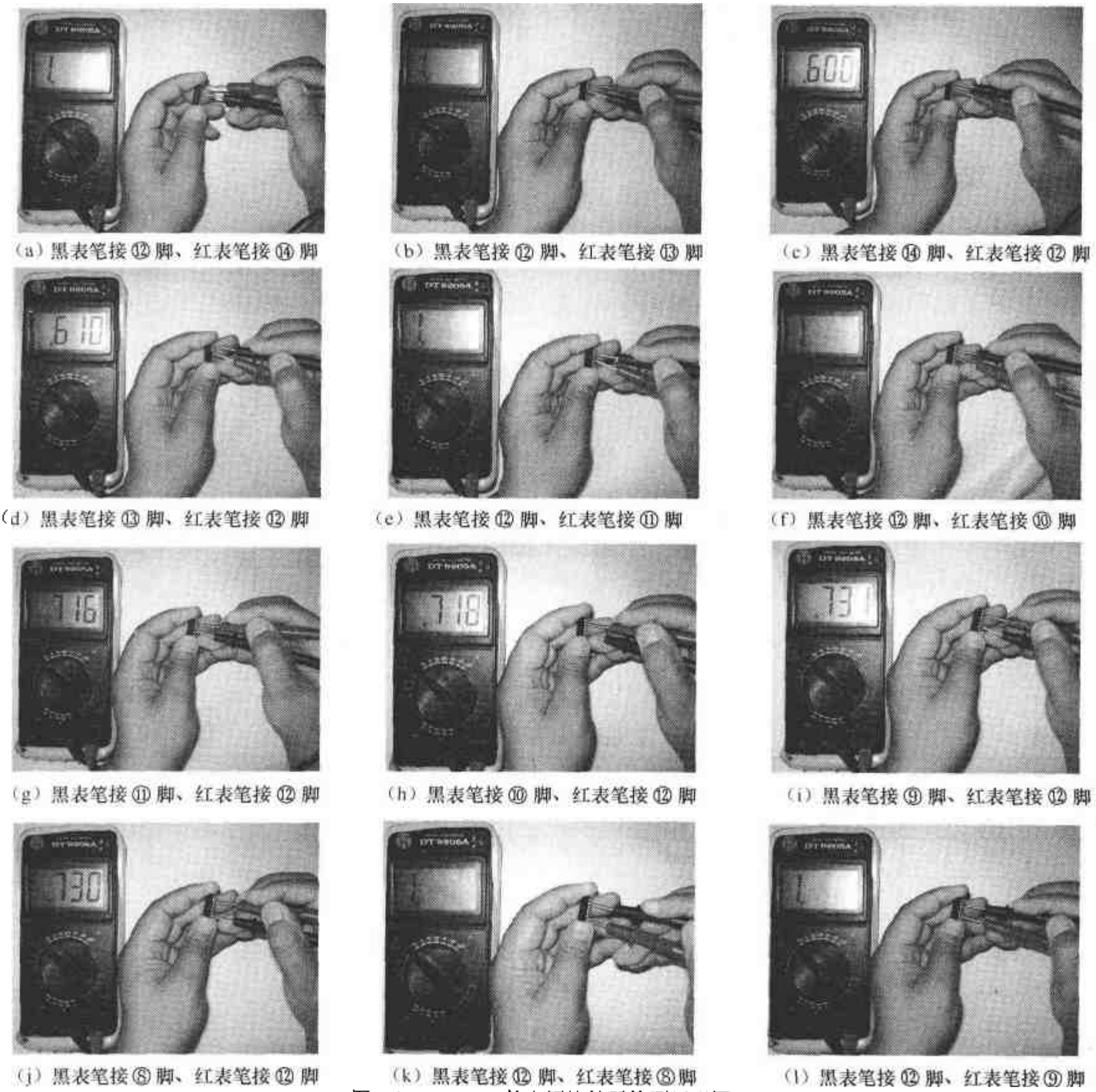
图 5-35 LM339 的电压比较器检测示意图
