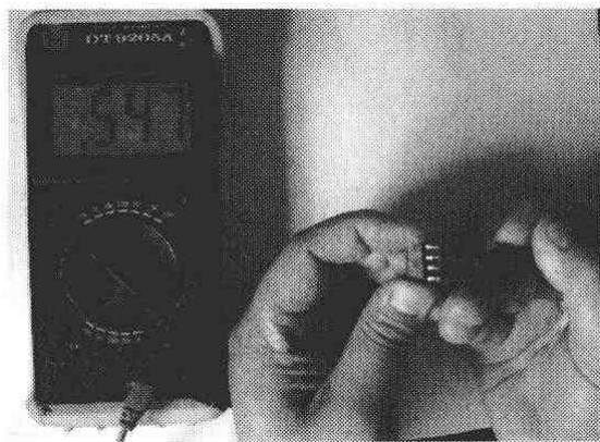
(a) AC、+脚间正向电阻的测量
