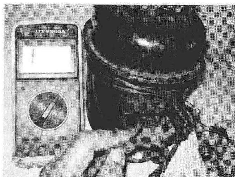
(d) 绝缘性能的检测
