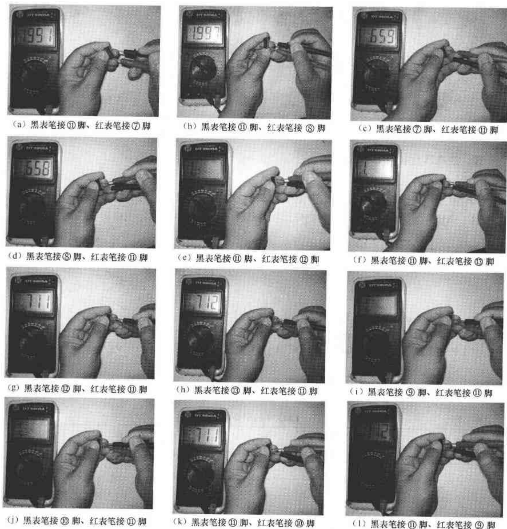
图 5-32 LM324 的运算放大器检测示意图
